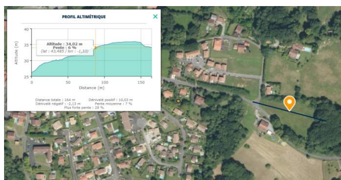
Coupe de terrain Est-Ouest (source Geoportail)
